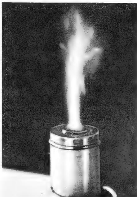
Bild 4. Prüfung eines Behandlungskopfes. Ein auf die schwingende Platte gebrachter Wassertropfen wird unter der Einwirkung der hohen Schalldrücke zu Nebel zerstäubt
