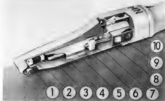
Bild 7. Der Tonabnehmerkopf des Philips-Plattenwechslers 2508 aufgeschnitten
